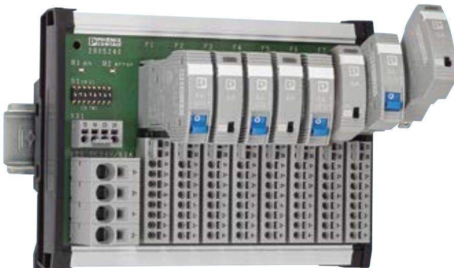
Рис. 1. СВВ – платы для установки автоматических выключателей. Хороший вариант решения для шкафов с большим количеством цепей нагрузки 24 V DC, требующих защиты, при ограниченном монтажном пространстве в шкафу
