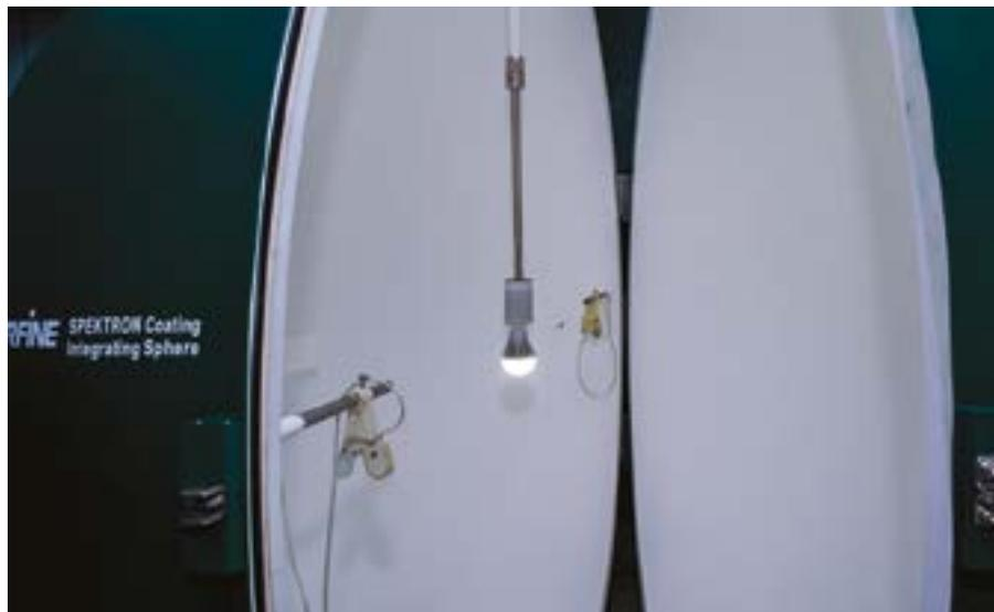
Фотометрический шар диаметром 2 м
