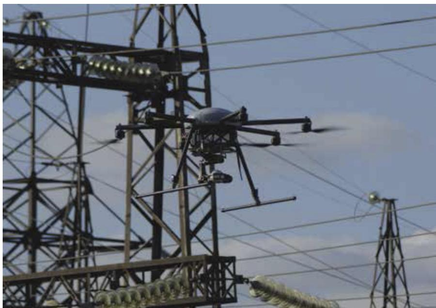
быть закреплены видео- и фотокамеры с обычной оптикой, а также камеры для тепловизионной и ультрафиолетовой съемки.
