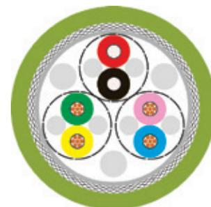
Рис. 2. Структура кабеля HMCB500S
