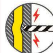
Механическое повреждение изоляции
