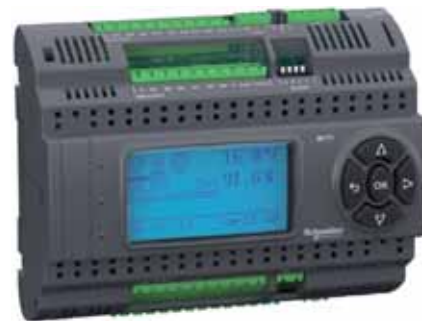
Рис. 4. Внешний вид контроллера Modicon M171 performance.
