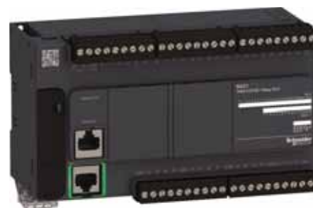
Рис. 6. Внешний вид контроллера Modicon M221.
