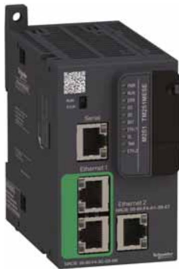
Рис. 10. Внешний вид контроллера Modicon M251.
