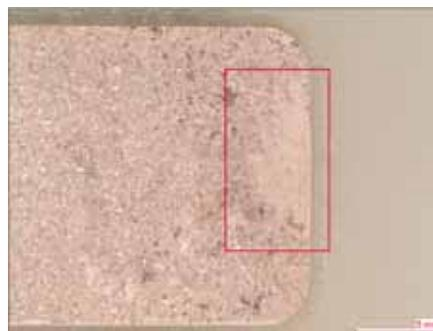
Фото 4. Структура поперечного шлифа после теста на предмет водородного охрупчивания (образец шины Россия); метка показывает область материала, подверженного «водородной болезни».
