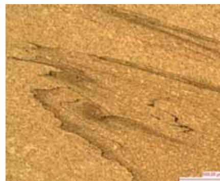
Фото 6. Массивное скопление кислорода в материале в увеличенном виде (светлое поле, легкое травление). Выделенный участок: Фото 5.
