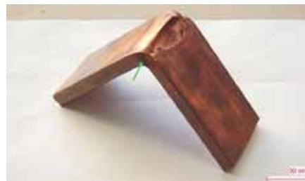
Фото 2. Образец № 1 с дефектом при изгибе.
