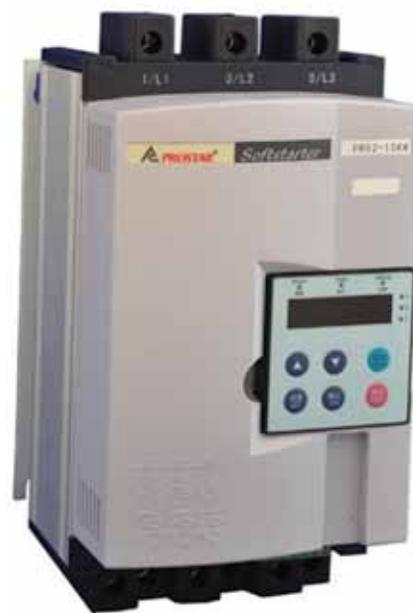
В отличие от множества других УПП устройства этой серии оснащены силовыми модулями – тиристорами по всем трем фазам, включенными по встречно-параллельной схеме, что обеспечивает управление всеми тремя фазами на протяжении всего периода работы.
