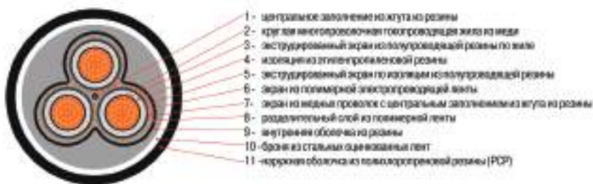
Конструктивные элементы кабеля марки EPRon® PПГиг(A)-HF 4x35 – 1 кВ, ТУ 16.К180-035-2012
