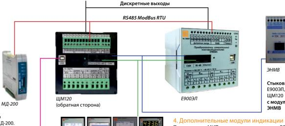
Принимают от МИП результаты измерения по RS485 и отображают (без потери точности) информацию в виде цифрового, стрелочного прибора, графиков.
