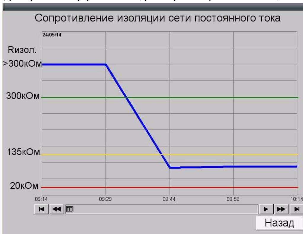
Рисунок 16. График сопротивления изоляции сети постоянного тока.
