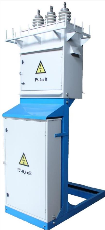
Комплектная трансформаторная подстанция столбового типа КТПС(М) мощностью 25-250 кВА представляет собой однострансформаторную подстанцию тупикового типа наружной установки и служит для приема электрической энергии трехфазного переменного тока частотой 50 Гц напряжением 6 или 10 кВ, преобразования ее в электроэнергию напряжением 0,4 кВ и энергоснабжения ею отдельных населенных пунктов и промышленных объектов.
