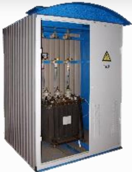
Комплектная трансформаторная подстанция киосковая типа КТПК мощностью 25-1000 кВА представляет собой одно(двух)трансформаторную подстанцию наружной установки и служит для приема электрической энергии трехфазного переменного тока частотой 50 Гц напряжением 6 или 10 кВ, преобразования ее в электроэнергию напряжением 0,4 кВ и энергоснабжения ею отдельных населенных пунктов и промышленных объектов.
