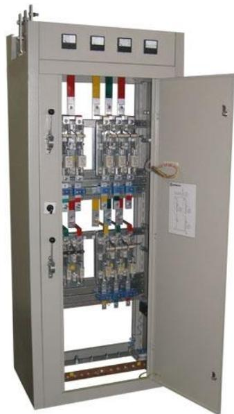
Панели серии ЩО70 предназначены для комплектования распределительных щитов напряжением 0,4 кВ трехфазного переменного тока частотой 50 Гц, которые служат для приема и распределения электрической энергии, защиты отходящих линий от перегрузок и токов короткого замыкания.
