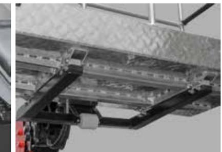
Специальные капролоновые проставки под полом корзины обеспечивают электроизоляцию до 1000 В. Ролик в нижней части узла крепления предохраняет корзину от удара о землю.
