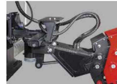
РВД и провода защищены. Электропроводка и шланги гидравлики расположены внутри стрелы.
