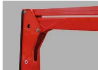
Запатентованная форма пантографа, обеспечивает параллельное движение стрелы относительно здания, сооружения или любого другого объекта и позволяет использовать автомобиль в узких пространствах.
