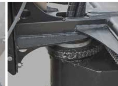
Металлическая шестерня и рейка поворота корзины обеспечивают надежность и четкую работу конструкции.
