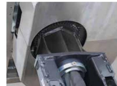
Вращение корзины вокруг вертикальной оси  $\pm 90^\circ$ .
