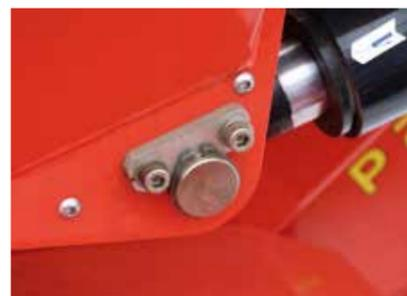
Все оси дополнительно фиксируются пружинными кольцами и имеют масленки для обслуживания.
