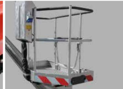
Корзина оснащена двумя входами с противоположных сторон и имеет специальную форму, позволяющую избежать ударов корзины о стрелу.
