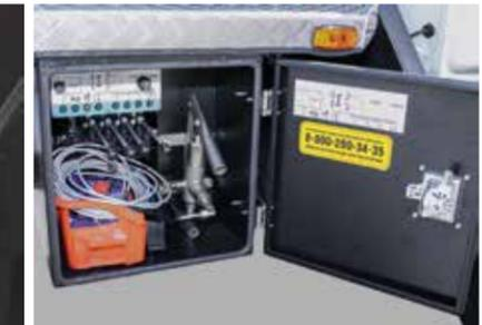
Ящик для перевозки гидрооборудования с внутренними компонентами установлен справа по борту шасси (аварийный насос, панель управления аутригерами).
