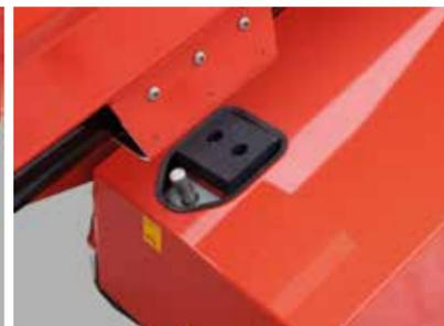
Концевой выключатель транспортного положения стрелы находится ближе к центру подъемника, поэтому при движении по неровной дороге меньше подвержен ударам.
