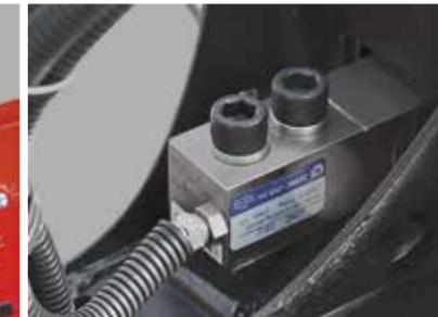
Система ограничения предельного груза построена на базе тензодатчика, который обладает большей точностью и стабильностью в работе по сравнению с механическими системами.
