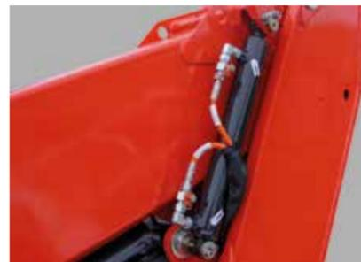
Регулировка горизонтирования автоматическая (перетечка рабочей жидкости в двух цилиндрах), нормальное положение клапана – закрытое, открывается при увеличении давления.
