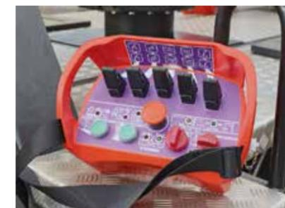
Электрогидравлическое управление АГП имеет два пульта: верхний закреплен в корзине в металлическом ящике, второй – переносной, штатно оснащен кабелем длиной 10 метров. Пульт управления в корзине – съемный.
