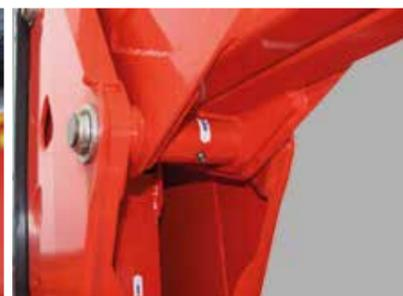
В нижней части стрелы поставлен пластиковый ролик для предохранения во время опускания люльки.
