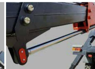
Гидроцилиндр телескопирования расположен снаружи и снизу стрелы, что обеспечивает достаточную защиту без необходимости увеличения сечения стрел.
