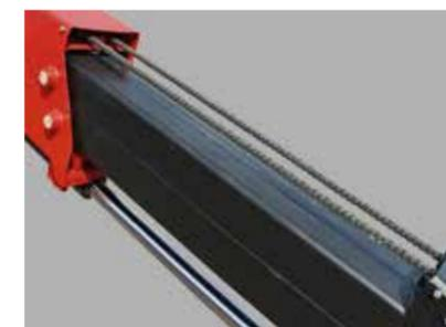
Цепная синхронизация выдвижения стрел обладает большей надежностью и долговечностью по сравнению с тросовой.
