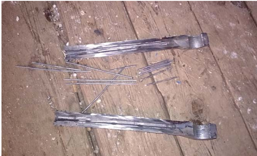
Разрушение стальных проволок сердечника провода при несоблюдении перекрытия матрицами при опрессовке
