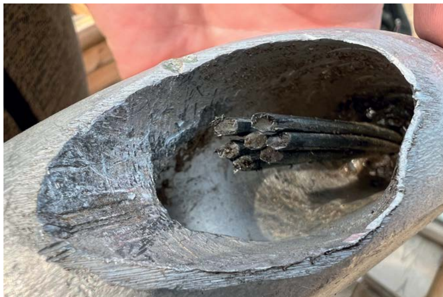
Обрыв провода при опрессовании меньшей по размеру матрицей
