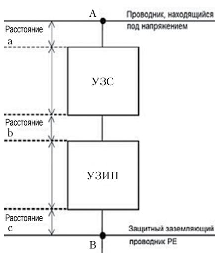
**Рисунок 8 – Подключение УЗИП**
