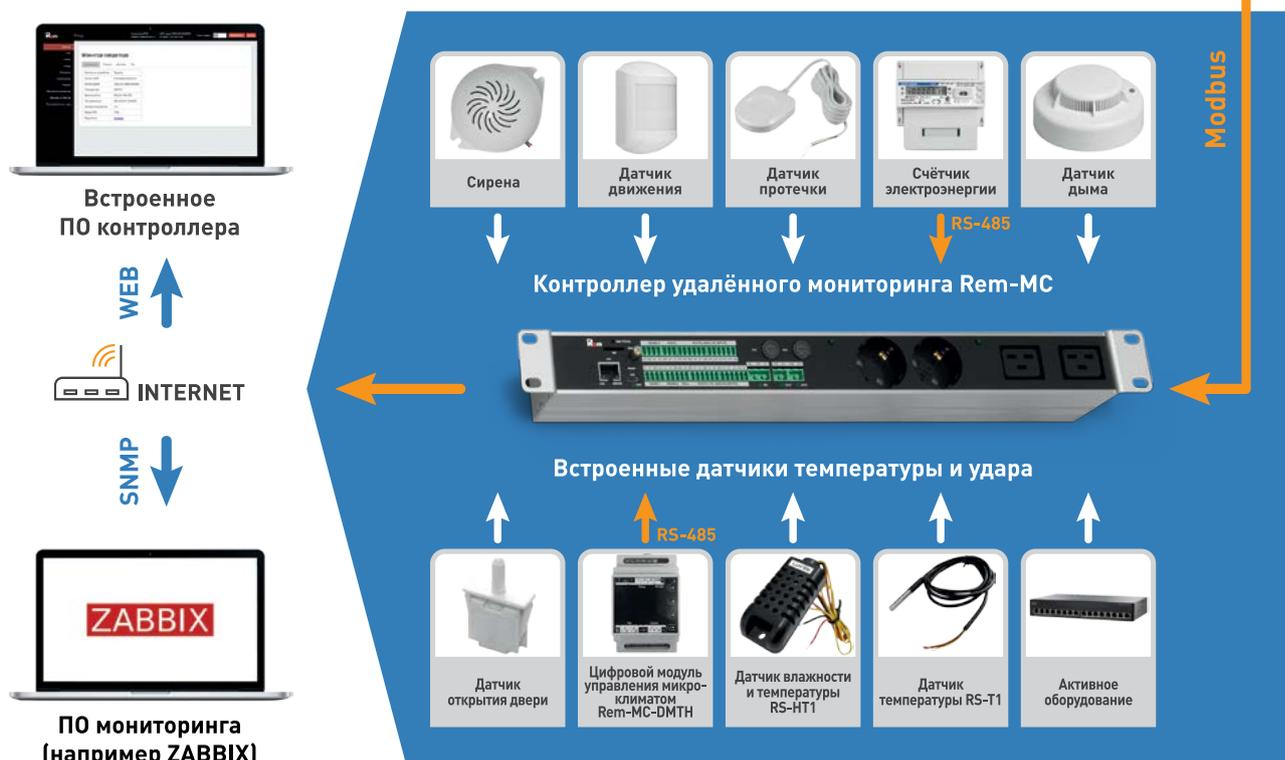
Система мониторинга и управления электропитанием на основе контроллера Rem-MC с удобным русскоязычным веб-интерфейсом позволяет в режиме реального времени:
