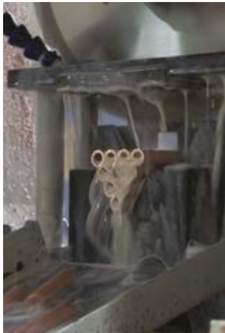
Порезка медных труб на заготовку при помощи автоматических тис
