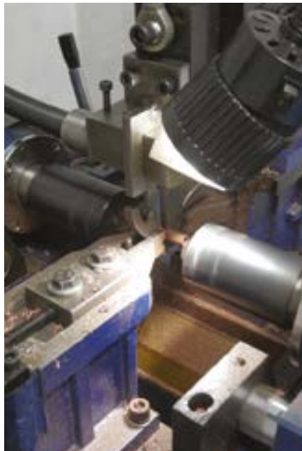
Снятие фаски с заготовки
